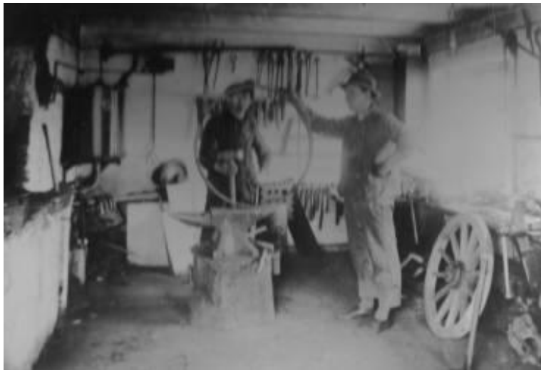
Smedemester Otto Høj og medhjælper er i færd med at smede en hjulbane til et vognhjul, ca. 1935. En vanskelig opgave. Ved kraftig opvarmning, udvides banen, der trækkes ned over hjulet, afkøles hurtigt med vand, hvorved banen trækker sig sammen, og banen sidder urokkelig fast ("krympning").
